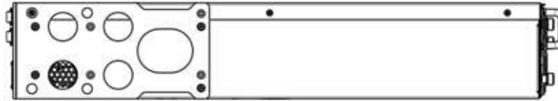
Рисунок 20 – Левая боковая панель ESR-1700
